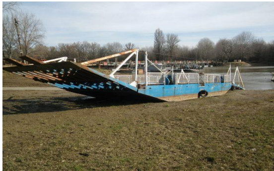
4./ Tiszán működő 20 tonnás és köteles kompok átalakíthatók 2*10 kW elektromotoros komphajóvá
