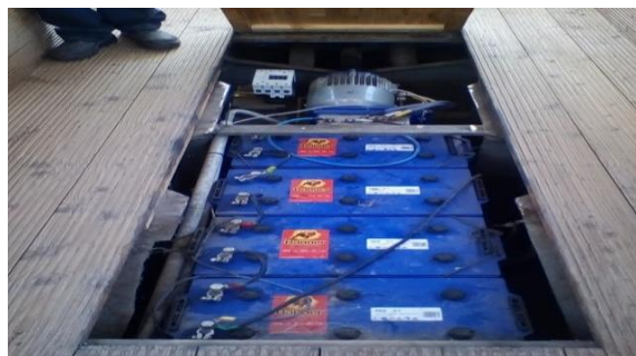
2./ Pásztor Révhajó Kft. 0,63 kWh/km villamos tolóerő fogyasztású első elektromos révhajó (10 tonnás)
